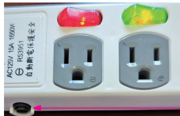
圖 12-3f 具有過載保護的延長線
