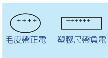
圖 1-2b 摩擦後電子跑到塑膠尺
