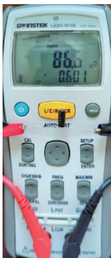
★ 圖 4-1b 電容量測
