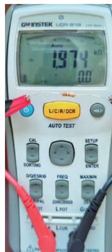
★ 圖 4-1c 電阻量測
