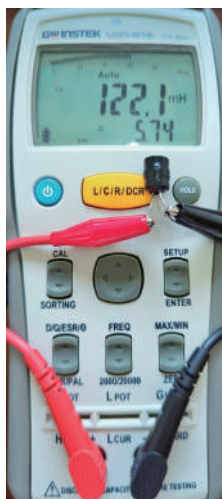
★ 圖 4-1a 電感量測
