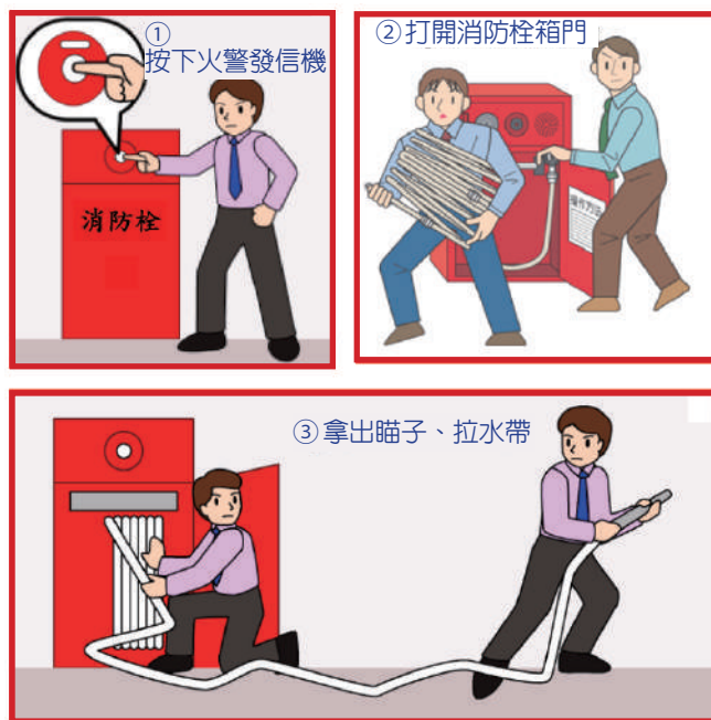
★ 圖 1-7 第 1 種消防栓使用步驟（摘自消防署）
