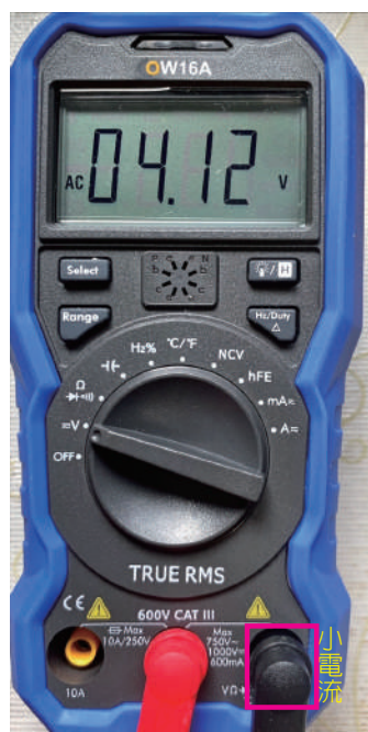
★ 圖 4-56a 交流電壓的量測
