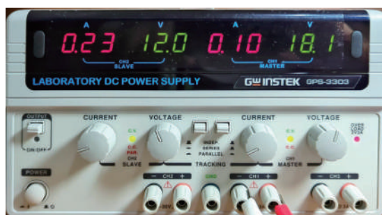
★ 圖 2-25a 電源供應器電流設定
